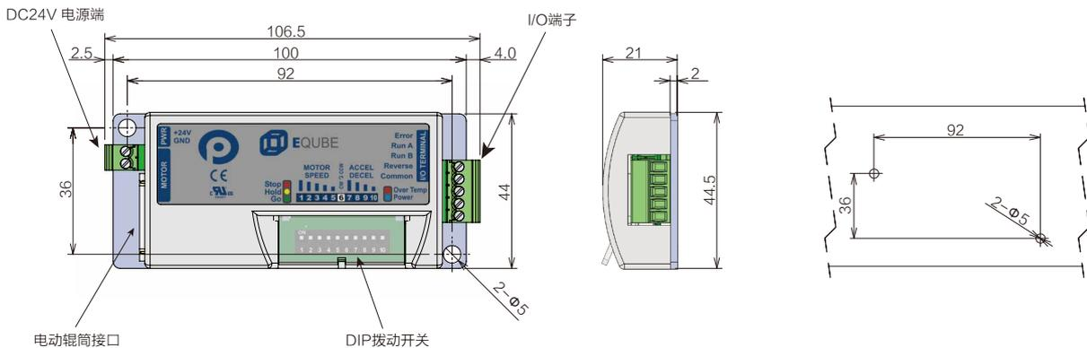
⚠ 为防止静电对驱动卡造成损害，请确保驱动卡背板有效接地，确保静电能被有效释放。
